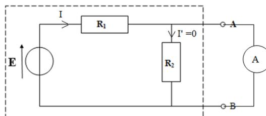
La loi d'ohm s'écrit  $E = R_1 I \Rightarrow R_1 = \frac{E}{I} = 12 \Omega$
